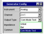
Remote control command: OUTPut:TYPE CTESt
